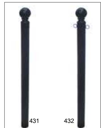
Paletto parapetonale Ø 80 mm. mod. "Paros" in acciaio verniciato H 130 cm, sfera in fusione di ghisa. 431 senza anelli 432 con anelli tendicaten
