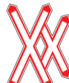
Fig. 10/d DOPPIA CROCE DI S. ANDREA INSTALLATA VERTICALMENTE
