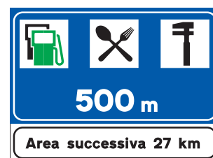
Fig. 376 AREA DI SERVIZIO AUTOSTRADA (colore di fondo verde) AREA DI SERVIZIO STRADA EXTRAURBANA (colore di fondo blu)
