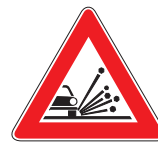
Fig. 29 MATERIALE INSTABILE SULLA STRADA
